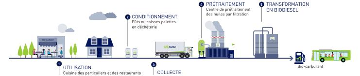
Grâce à une réaction chimique entre l'huile et l'alcool il est possible de produire du biodiesel. On appelle ce procédé la transestérification
